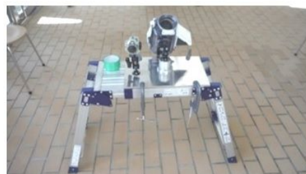
図1 提案するマルチアングルカメラシステム例
