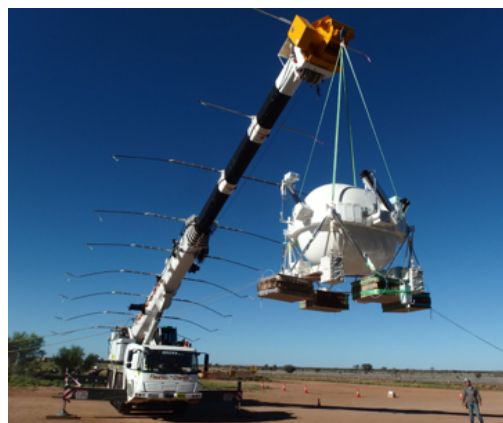
図1: GRAINE2018気球実験のために開発した与圧容器ゴンドラのフライト準備完了時の様子。内部にエマルジョン望遠鏡を搭載し300 hPa程度の差圧を保持している。外部には姿勢モニター・スターカメラ3台を設置している。
