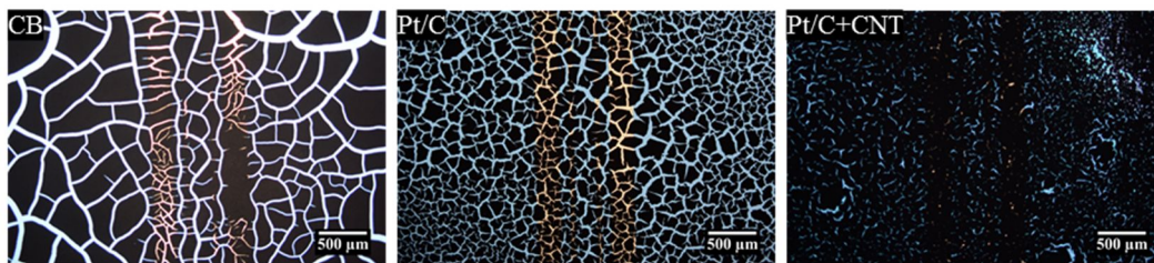
図 7 . 形成された多孔質構造におけるマイクロクラック .
