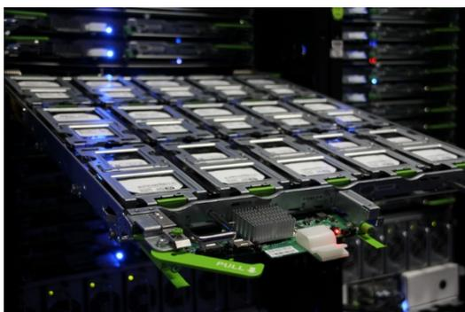
図1 データセンター内に格納された HDD : HDD は密集して配置されている (図は15台) ため、動作時の発熱や動作時における振動が互いに影響を受けやすい環境となっている。
