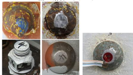
写真1 採取したボルト例 写真2 ひずみゲージ法
