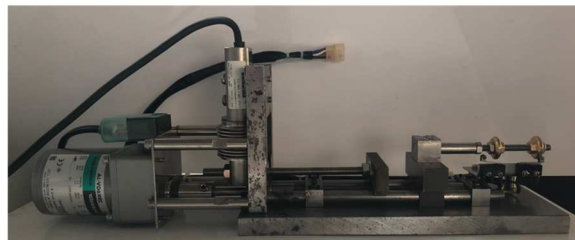
写真1 自動化させた荷重測定装置
