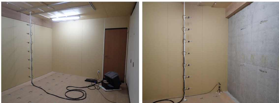
図7 マイクアレイと対象のRC壁(右)・複合壁(左)
