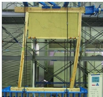
図11 開口部を有する実大土塗壁の静的載荷実験
