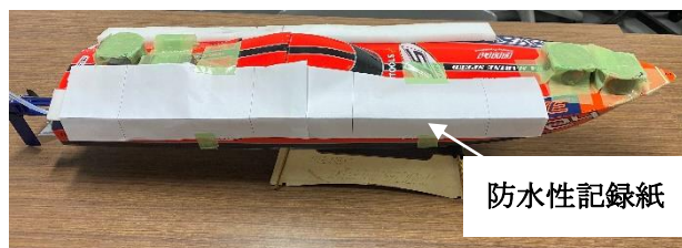
図 5 被衝突船への記録紙設置状況
