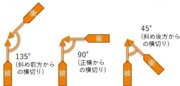
図6 被衝突船針路を基準として定義した衝突角の例（衝突船と被衝突船の船速が同一である場合の例）
