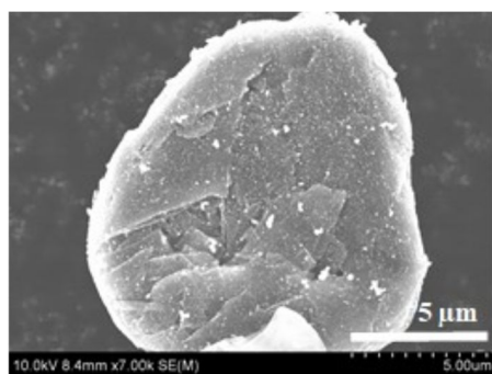
図 3 0.125 \text{ mol}\% \text{LiGaO}_2 被覆黒鉛粒子の SEM 像
