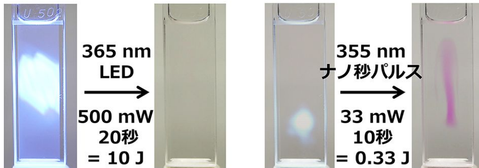
図 2 . フォトクロミックローダミン誘導体溶液に UV LED (365 nm, 500 mW) を 20 秒間照射したとき ( 左 ) と、ナノ秒パルスレーザー ( 355 nm, 33 mW ) を 10 秒間照射したとき ( 右 ) の着色変化
