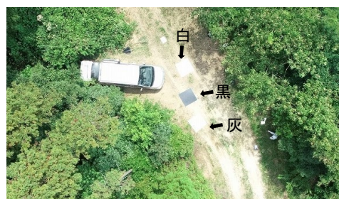
図 3 キャリブレーションパネルの設置
