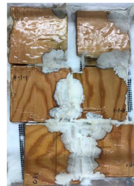
図3 腐朽処理終了時の培養容器の様子
