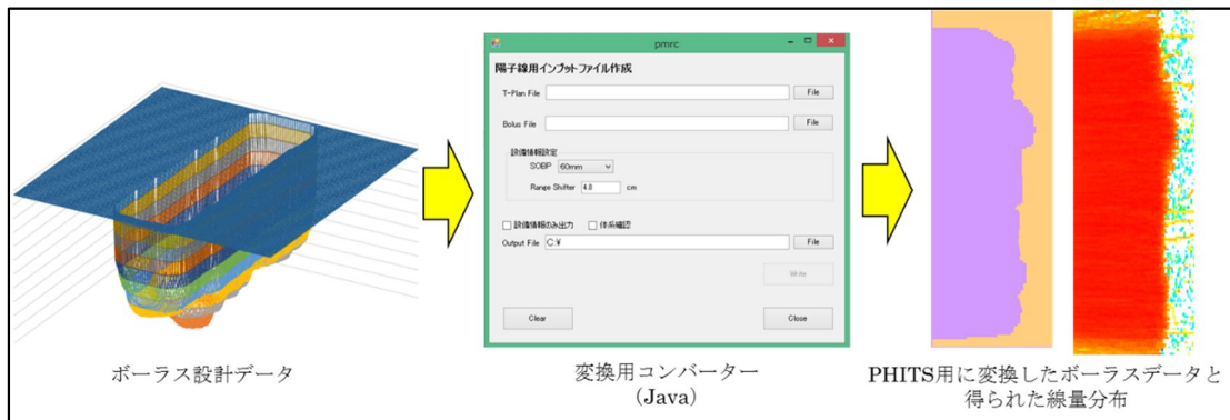
図 3 本研究で作成した変換プログラムによって得られたボラスを考慮した線量分布
