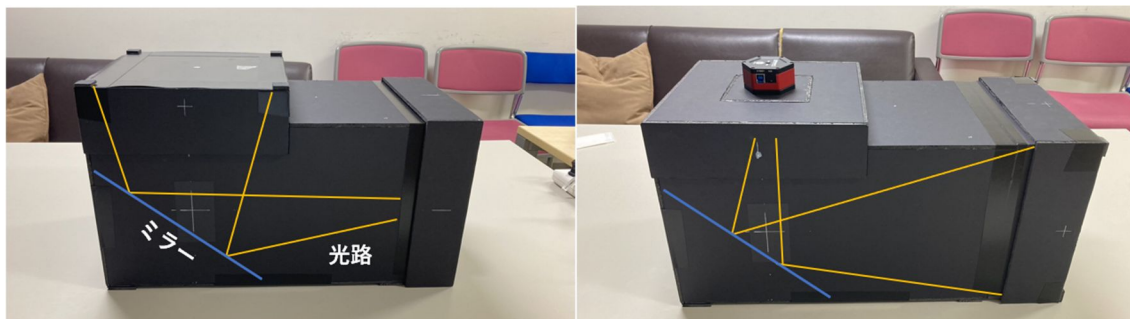
図1 想定している2次元線量分布測定器。左図はシンチレーター検出器が上、カメラが右側に位置する。この配置では Cronal 面や Sagittal 面での測定が可能。一方右図ではカメラが上、シンチレーター検出器が右側に配置している。この配置では Axial 面での測定が可能。
