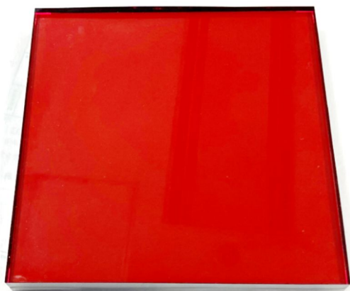
図 4 放射線照射により黄変したアクリルとシンチレータープレートの一様な発生光量。ムラが出ているのが分かる。
