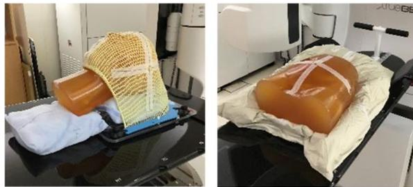
図 3. X線撮像に使用した頭部ファントム(左)と骨盤部ファントム(右)
