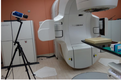
図 2. a) TrueBam および b) CyberKnife でのチェレンコフ光の測定の様子。 アフィン変換用にチェッカーボードを利用。
