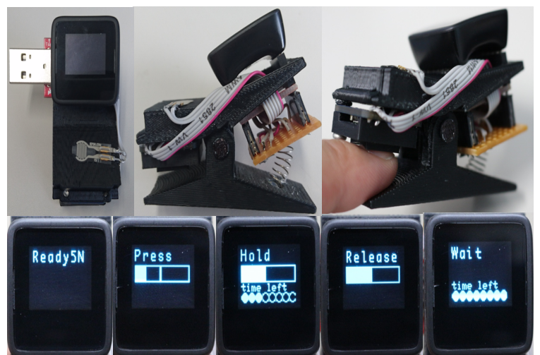
図3 フィードバック機能を搭載した小型測定装置
