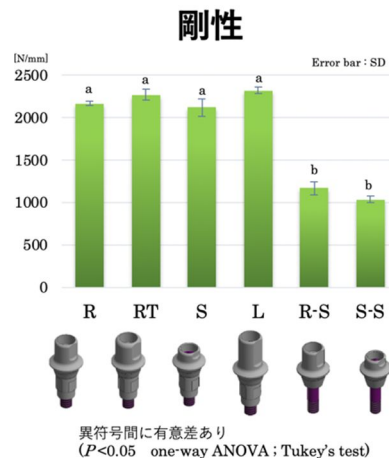
(図6) 各型における静荷重時の静的破壊荷重と剛性の比較
