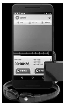
Fig.2; 画面上での情報 専用のアプリを使用し、 嚥下回数、嚥下時間など 情報の表示、記録が可能である。
