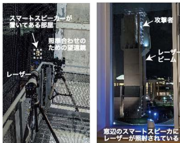
図4 70 メートル離れた隣の建物から、窓ガラス越しにレーザーを照射することで音声コマンドを挿入する実証実験の様子
