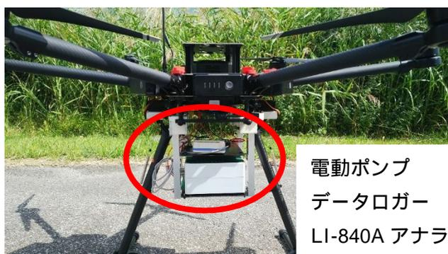
図1 CO<sub>2</sub>観測用ドローンシステム
