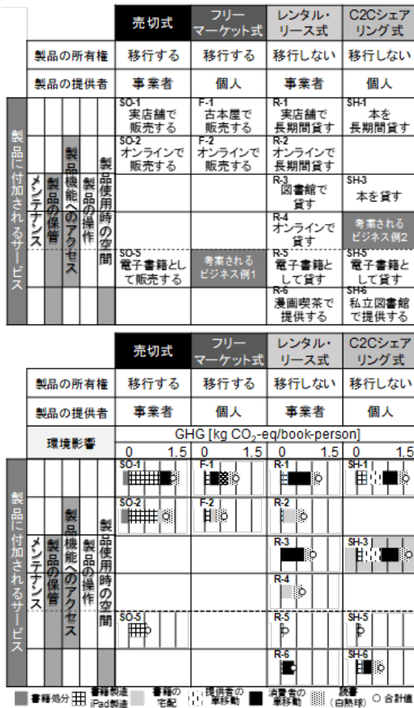
図 1 (a) 製品機能の消費パターン分類表; (b) 書籍コンテンツの各消費パターンの環境影響評価結果
