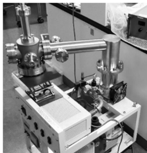
図2 超低エネルギーEB照射装置外観
