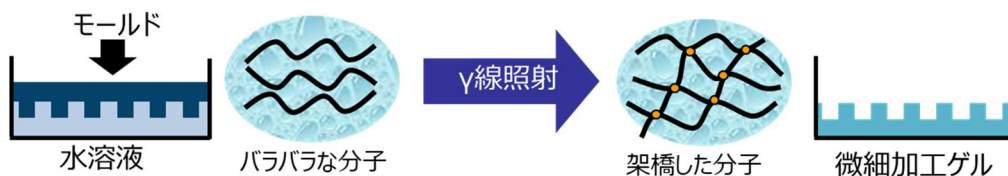
図1. 量子ビームインプリント技術による微細加工ゲルの作製法
