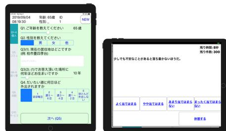
図2. 試作した入力用インタフェース。左図が初期のもので、高齢者からの意見を踏まえ右図のように改良した。
