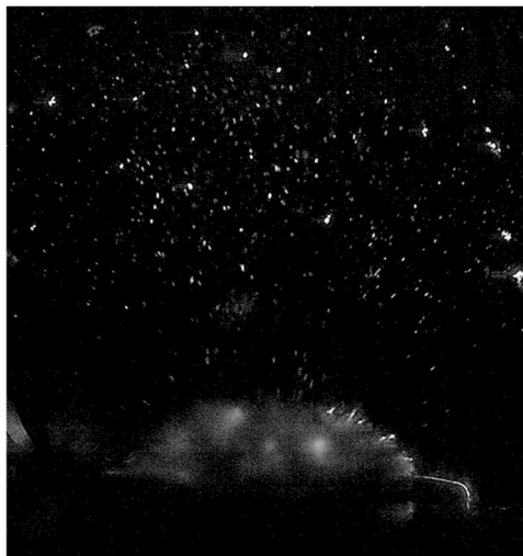
図 1. He II 沸騰周りの流れの可視化 (沸騰気泡とトレーサ粒子が同時に捉えられている)
