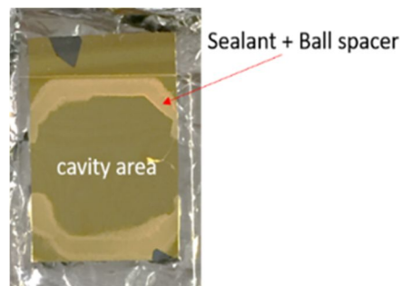
図3 中空構造を含むSPRセンサの写真。ガラス基板の大きさは2.4 cm x 3 cm。
