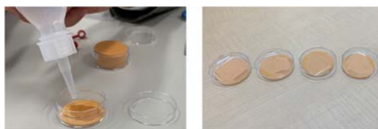
図 3 含水率較正用パッド (実験 IV)
