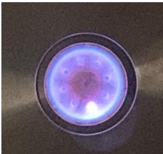
図5: セシウムを燃料とした際の放電の様子。
