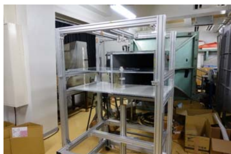
図3 低速吹き出し風洞とその計測部
