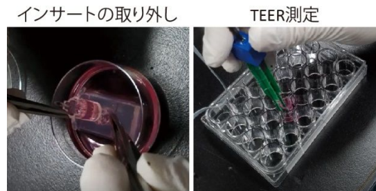
図5. カルチャーインサートの取り外しとTEER測定の様子
