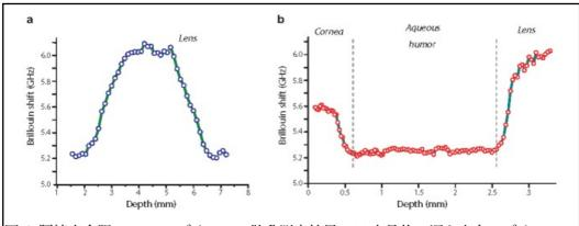
図 4 豚摘出全眼の in vivo ブリユアン散乱測定結果。(a)水晶体の深さ方向のブリユアンシフト。(b)前房の深さ方向のブリユアンシフト。測定は 5 回の測定の平均値。
