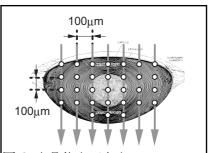
図 2 水晶体表面方向 100μm ステップ, さらに共焦点光学系を利用して光軸方向 100 μm ステップで3 次元弾性イメージング計測を実施する。図中の白丸が測定点例。
