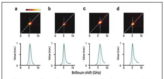
図3 豚摘出眼 (a)角膜,(b)房水,(c)水晶体,(d)硝子体のブリユアン散乱測定結果例。 Top panels は, CCD イメージ,bottom panels はそれぞれに対応したスペクトル。
