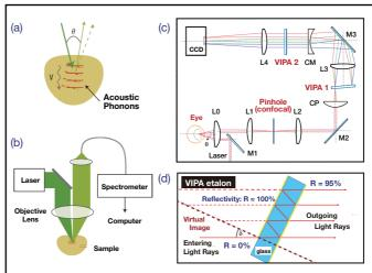
図 1 共焦点ブリルアン顕微鏡システムの概要。(a)音響フォノンによるブリルアン散乱。(b)共焦点ブリルアン顕微鏡システムの構成。図中の Spectrometer が図 1(c)のタンデム型分光器。(c)共焦点顕微鏡(M1 から L2)+タンデム型分光器(CP から L4)の光学系。VIPA エタロンをタンデム型にする(VIPA1 に VIPA2 を追加)ことにより、分解能を向上させ、波長 780nm のレーザーを使用可能にする。L0:対物レンズ、L1/L2/L3/L4:集光レンズ、CP:平凸円筒レンズ、CM:平凹円筒レンズ、M1/M2/M3:ミラー(d)VIPA エタロン(VIPA 1): VIPA ガラス板からの出射光は分光されて出射され、焦光レンズ(図 1(c)の L3)によってミラー(図 1(c)の M3)に波長ごとに異なる位置に集光される。
