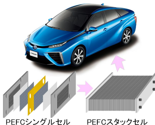
図1. 固体高分子形燃料電池(PEFC)を搭載した燃料電池自動車. 図中に実装 PEFC の概念図も示す.
