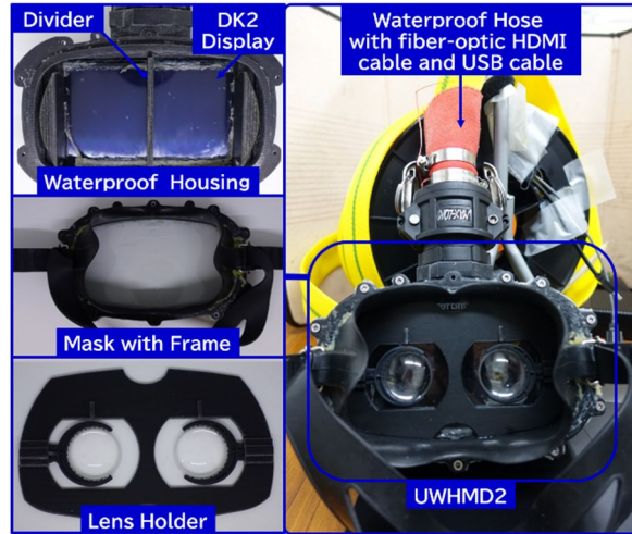
図1 左：頭部搭載型水中ディスプレイの要件および仕様 右：試作した頭部搭載型水中ディスプレイ
