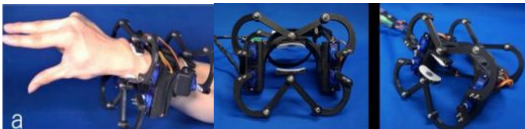
図2：多指に対する触覚を前腕部に転移させるシステム
