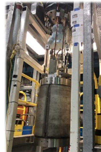
図 7 10T 外部磁場印加用 Nb 3 Sn コモンコイル磁石
