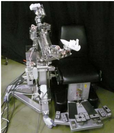
試作した自動追従型手台。 瑞穂医科製マイクロチェアに取り付けてある。
