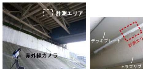
図4 疲労き裂の遠隔計測
