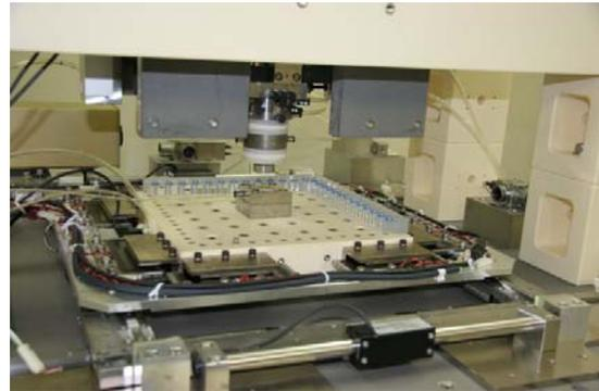
図 2 ハイブリッドリニア駆動平面ナノ位置決めテーブルシステム
