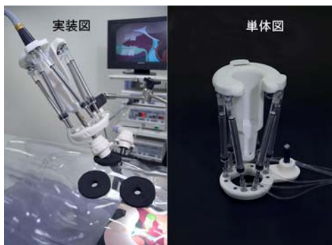
図1 内視鏡手術ツールの把持機構（内視鏡ロボット）。左：実装図（内視鏡を把持・操作している例）。右：単体図（6本の人工筋肉アクチュエータに取り囲まれた中央部分に内視鏡などの手術ツールを装着して利用する）。 Nature Vol. 461, Sep 17, 2009
