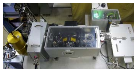
図 1 本研究で開発したミリ波分光エリプソメータの構成図および写真
