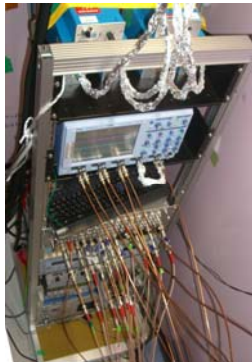
図4 J-PARCにおけるセミリジッド配線を用いた測定系。
