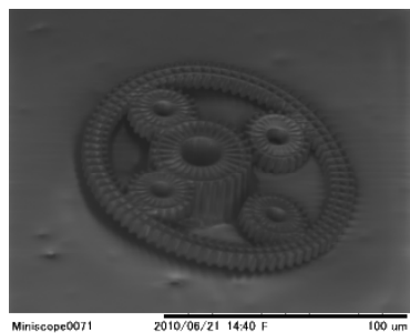
図4 2種類のエネルギーのマイクロビーム描画により形成した遊星歯車構造
