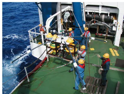
図2 海底電磁気計（OBEM、写真中央）の投入作業
