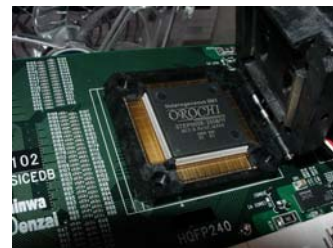
写真2: 命令分解型異種命令混在実行プロセッサ OROCHI
