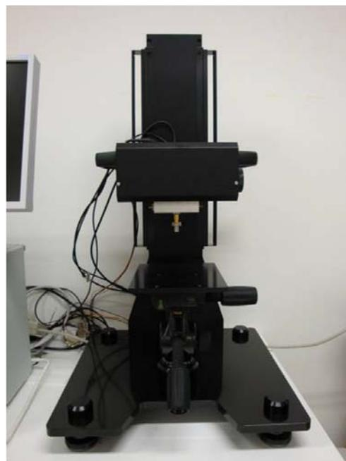
図 1 高解像度三次元超音波診断システムの外観
