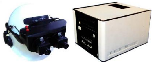
図1 カメラ付きヘッドマウンテッドディスプレイ (HMD) システム試作機
