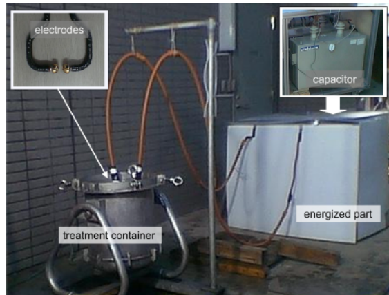
図7．水中放電を利用した衝撃波処理装置
