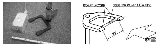
図1 吹雪計測システム(ABS)のセンサー一部(左)とその概要(右)
